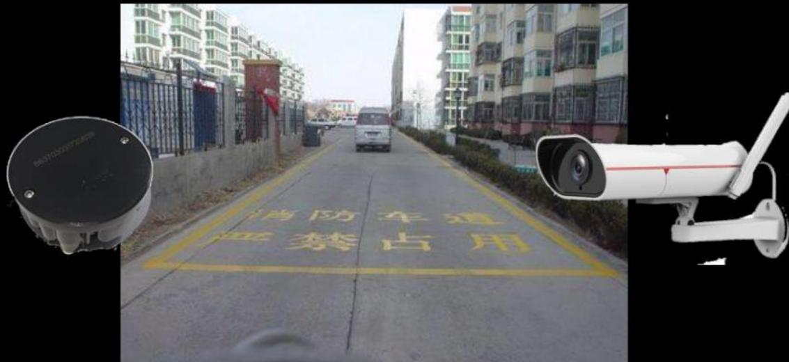
地磁传感器可监测是否有车辆停在其上方，安装于消防通道路面，侦测是否有车辆违规范停放，保持消防通道通畅，可联动附近摄像头，拍照取证
